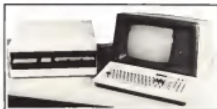
2 Megabytes su 2 drives 5 pollici - 64 KRAM - CPU Z80A - Display 2000 caratteri con linea di status - Tastiera 70 tasti con pad numerico e funzione
